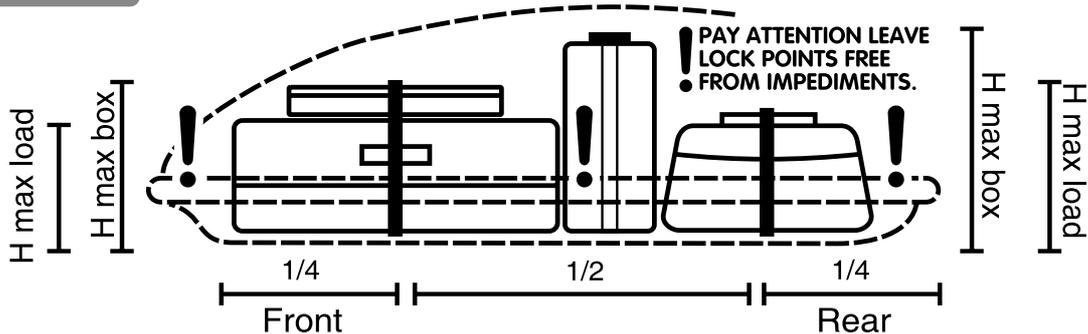
**POSIZIONAMENTO DEL CARICO - LOAD ALLOCATION - LASTVERTEILUNGALTERNATIVE**
