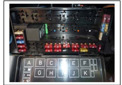
Sicherungskasten mit Original-Relais vorher
