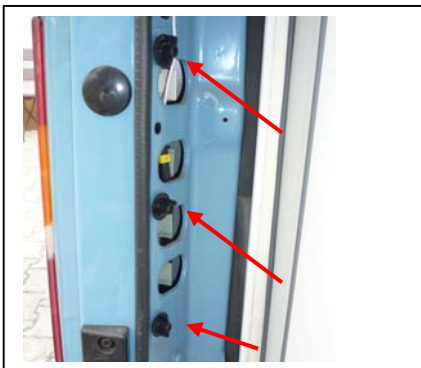
Rücklicht links. Kunststoff-Flügelschrauben lösen
