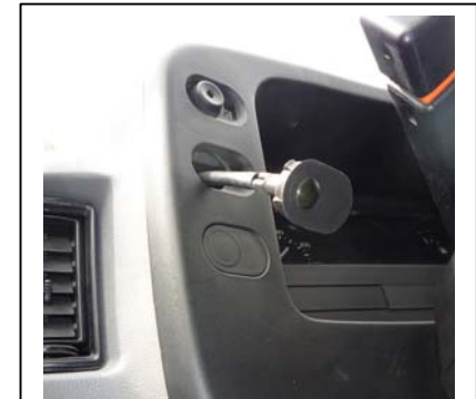
Einbau Kontrollleuchte ohne Demontage Cockpit
