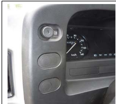
Cockpit vor Einbau Kontrollleuchte
