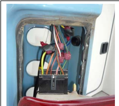
Anschluss E-Satz an Rücklicht links
