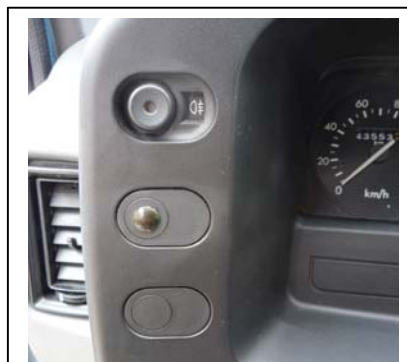
Fertig eingebaute Kontrollleuchte
