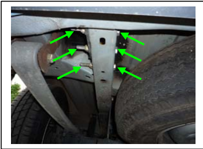
Stoßfänger-Schrauben links lösen
