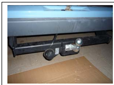
Fertig eingebaute Steckdose
