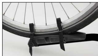
Figure 12 : Fixation de la roue avant
