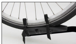
Figura 12: Fissaggio ruota anteriore
