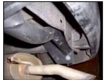
Anbau der AHK rechts
