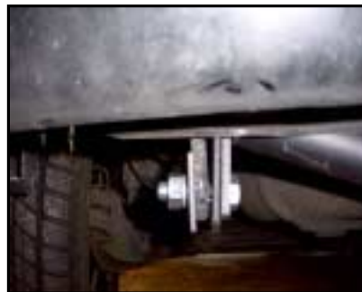
Anbau der AHK
