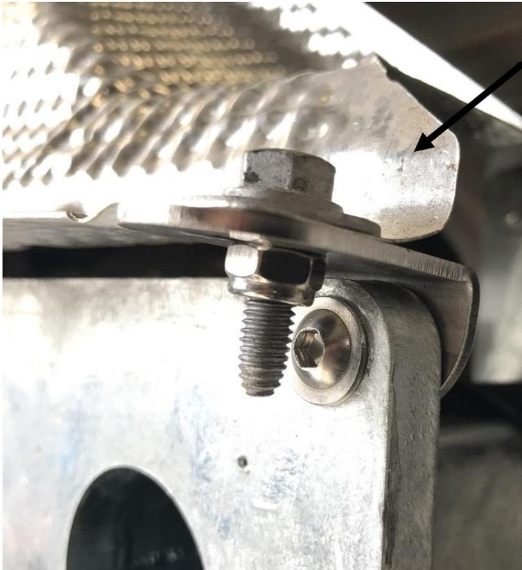
Setzen Sie das Wärmeleitblech
