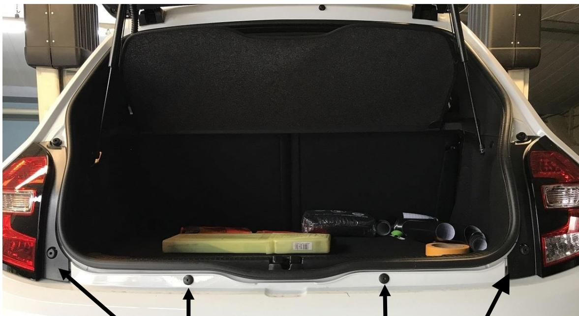
Entfernen Sie diese vier 25er Torx-Schrauben
