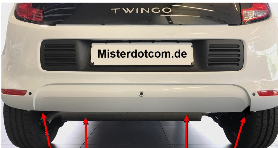
Entfernen Sie diese vier 15er Torx-Schrauben. Die äußeren Schrauben befinden sich an der Unterseite der Heckverkleidung.
