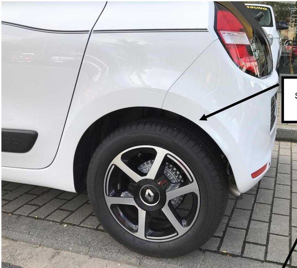
Entfernen Sie diese 15er Torx Schraube an der Innenseite des Kotflügels auf beiden Seiten
