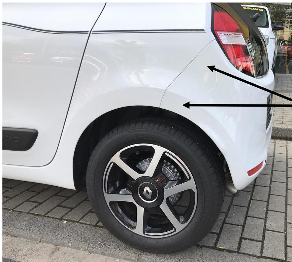
Auf beiden Seiten des Kotflügels an diesen Stellen ziehen und so den Kotflügel ausrasten.
