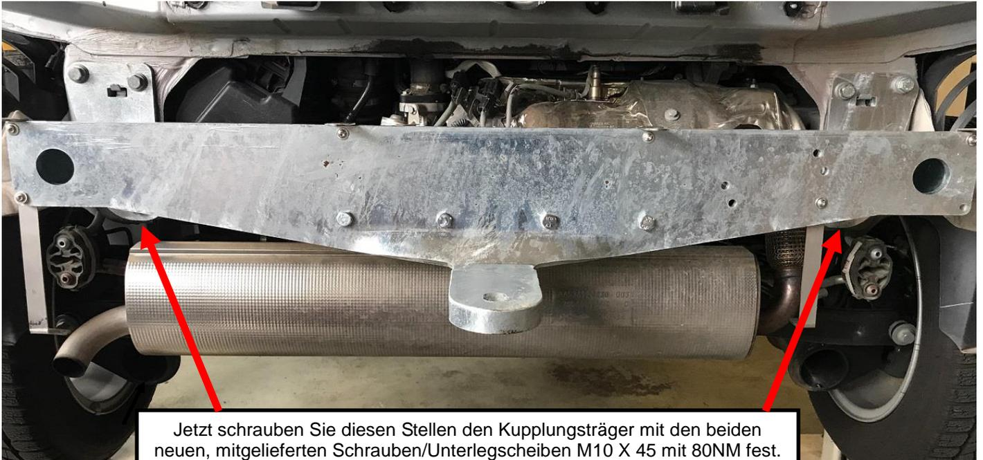
Jetzt schrauben Sie diesen Stellen den Kupplungsträger mit den beiden neuen, mitgelieferten Schrauben/Unterlegscheiben M10 X 45 mit 80NM fest.
