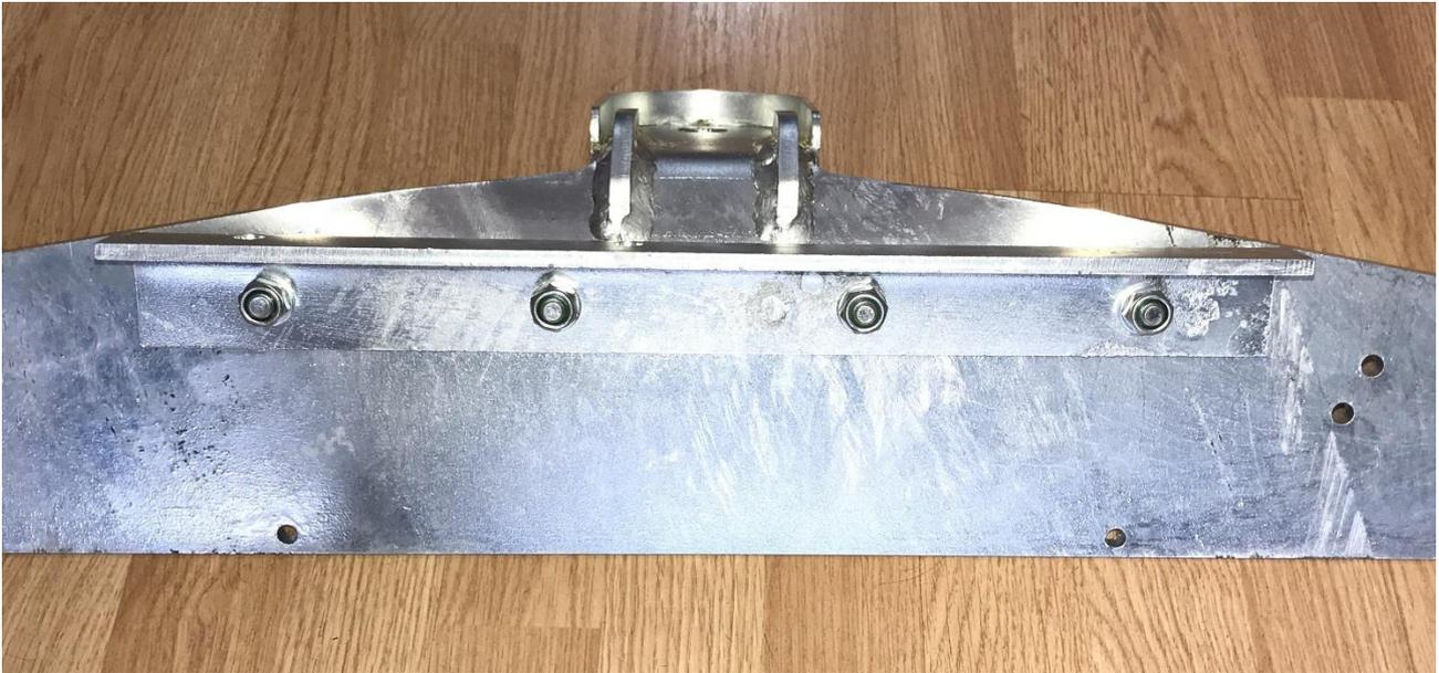
Montieren Sie das Verstärkungsblech/Winkel wie auf den Bildern zu sehen auf den Kupplungsträger mit den mitgelieferten Schrauben M10 X 30 sowie den Muttern/Unterlegscheiben M10 bei 80Nm
