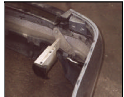
entfernte Stoßstange mit Grundträger
