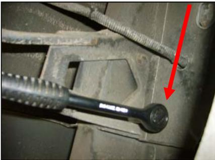
Abschleppöse demontieren und danach Auspuff aushängen
