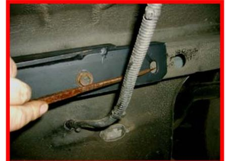
Die AHK mittels der Anschraubpunkte für die Abschleppöse fixieren. Danach kann man die Löcher „A“ mittels eines spitzen Gegenstandes anreißern. Danach (am besten mit wieder abmontierter AHK) vorkörnen und die Löcher bohren. Danach nach Vorgabe vergrößern
