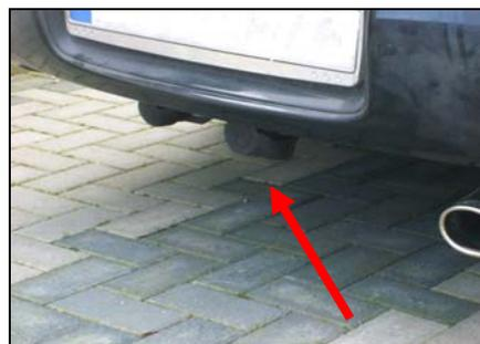
Fahrzeug fertig mit abgenommener Kugelstange
