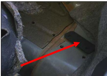
Montage der Druckplatten im Kofferraum
