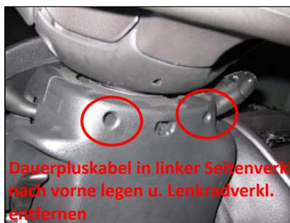
Dauerpluskabel in linker Seitenverkl. nach vorne legen u. Lenkradverkl. entfernen
