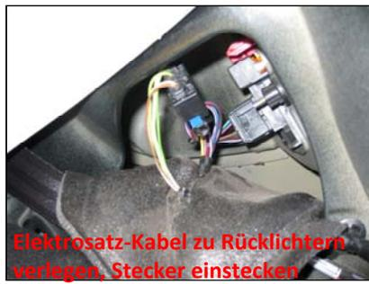
Elektrosatz-Kabel zu Rücklichtern verlegen, Stecker einstecken
