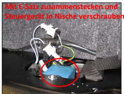
Mit E-Satz zusammenstecken und Steuergerät in Nische verschrauben
