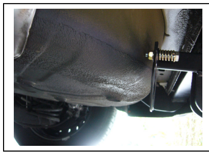
Halterung Stecker anbauen Feder gehört links von der Halterung
