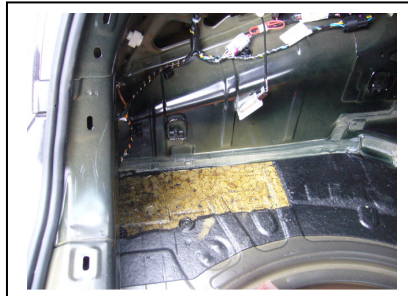
vorgestanzten Boden mit Heißluftföhn und Spachtel Entfernt (Links)
