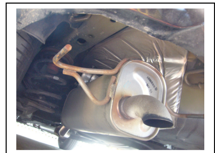
entfernen der Gummihalterung 2x
