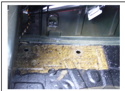
Markierte Löcher Bohren (Links)
