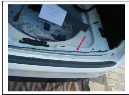
Kabelführung zur rechten Seite
