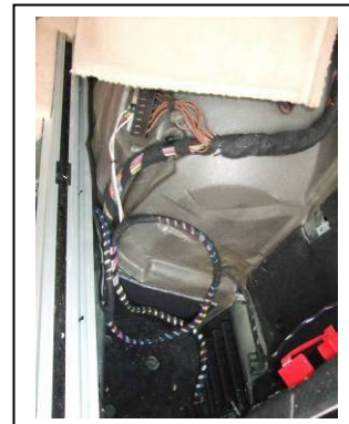
Massepunkt unter Seitenverkleidung
