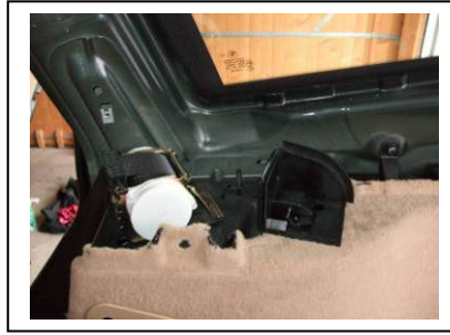
Gurthalterung und Fensterverkleidung abnehmen
