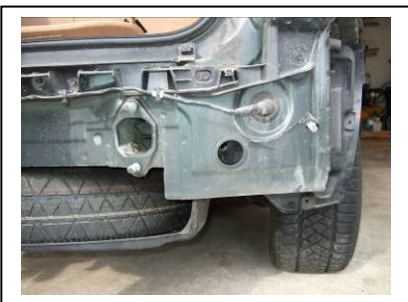
Originalen Gummistopfen entfernen
