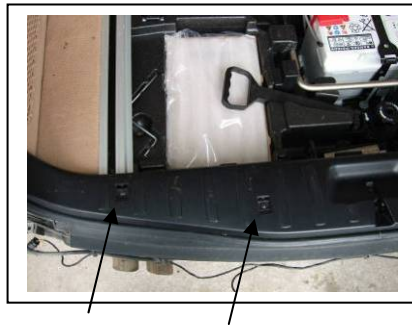
2 Clipse + 2 Schrauben entfernen
