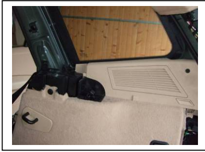
C-Säulen-Verkleidung und Deckel abnehmen
