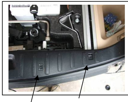
2 Clipse + 2 Schrauben entfernen
