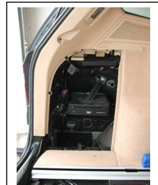
Verkleidung links abnehmen (gesteckt)
