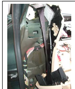
Sitz umgeklappt, Seitenverkleidung vorgezogen
