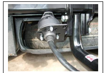
Montage Steckdose (auf Bild gedreht)
