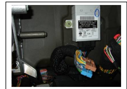
Zerlegter Stecker im Fahrerfußraum (Lichtmodul)
