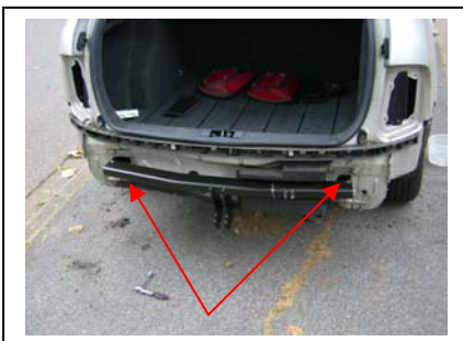
AHK mit Tragarmen in Chassis eingeschoben
