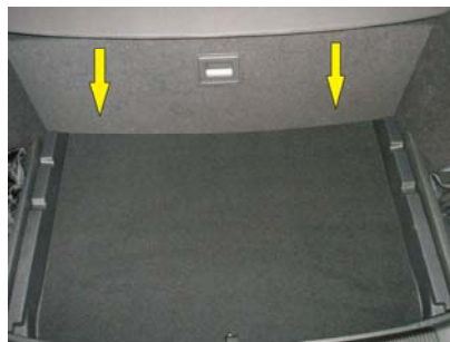
Nach dem Ausbau der Stauklappen, in dem Mittelsteg zwischen dem kleinen und dem großen Staufach, 2 Muttern mit 10er Maulweite lösen und den Rahmen komplett aus dem Fahrzeug entnehmen.
