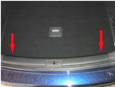
Schwellerverkleidung 2 Torxschrauben lösen und hochheben
