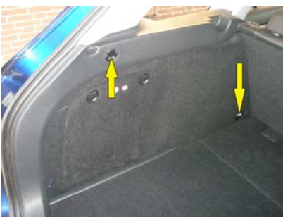
Links 1 Torxschraube lösen und die Zurröse demon- tieren. Rechts 2 Torx- schrauben lösen und die Zurröse demontieren.
