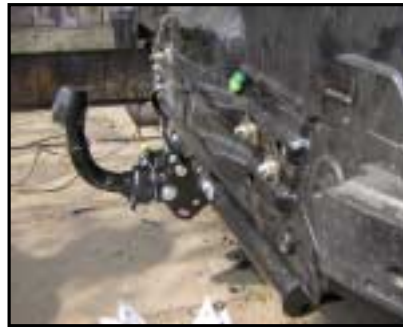
Anbau der AHK
