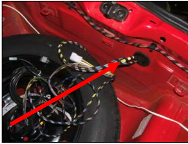
Kabelstrang am Heckblech nach außen
