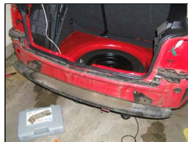
Stoßfänger hinten demontieren
