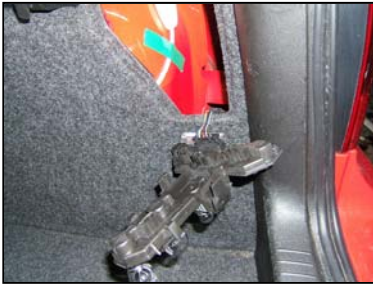
Lampenträger vom rechten Rücklicht entfernen
