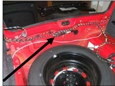
Kabel fest verlegen
