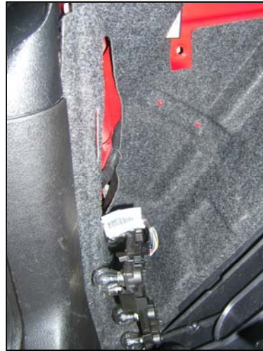
Lampenträger vom linken Rücklicht entfernen
