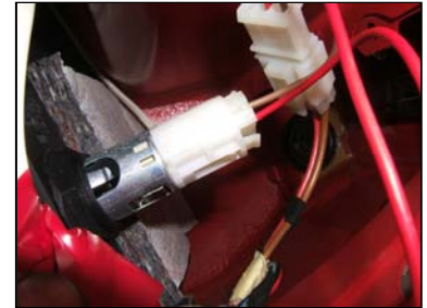
Steckadapter auf die 12V-Steckdose anschließen
