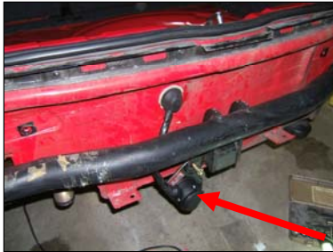
Steckdose am Halter montieren
