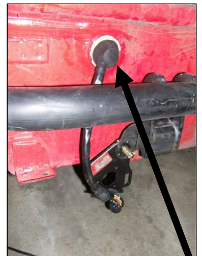
Kabelstrang am Heckblech nach außen führen
