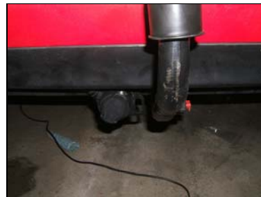
Steckdose montiert von hinten
