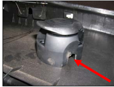
Seitliche Sollbruchstelle des Steckdosengehäuses bearbeiten
