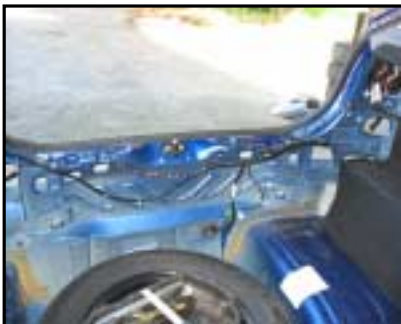
Anschluss des E-Satzes, Kabeldurchführung
