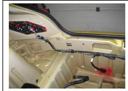
verlegter Kabelbaum von der Durchführung bis zur rechten Rückleuchte
