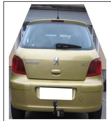
fertig angebauter Elektrosatz mit Anhängerkupplung
