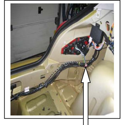
montierter Kabelbaum an der linken Rückleuchte
