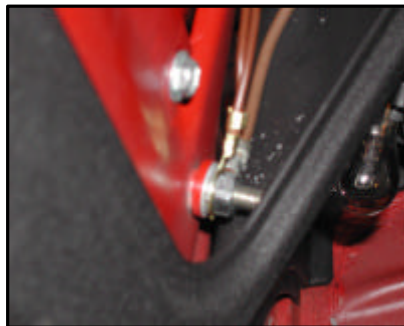
Anschluss des E-Satzes Massekabel
