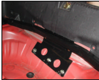
Anbau der AHK
