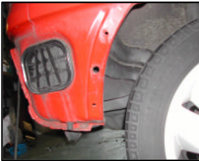
Abbau der Stoßstange
