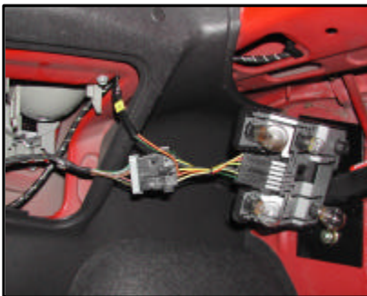
Abbau der Verkleidungen, Anschluss E-Satz
