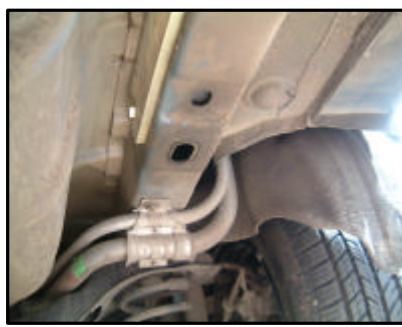
Anbau der Ahk, Halter rechts am Rahmen
