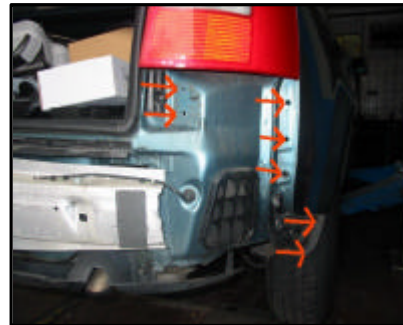
entfernen des Stoßfängers (Befestigungspunkte)
