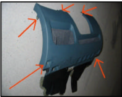
Abbau der Verkleidung im Fußraum der Fahrerseite (Befestigungspunkte)
