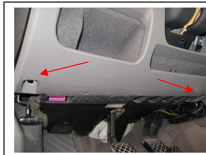
Verkleidung über Lenkrad ausclippen und 2 Schrauben lösen. Zudem 2 Schrauben im Fußraum lösen.
