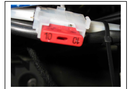
10A Sicherung in Sicherungshalter einstecken und mit Kabelenden verbinden.
