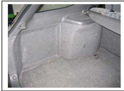
linke Seitenverkleidung (3 versteckte Plastikclipse=> 2 unter Sitzbank, 1 zwischen der Rückenlehne)
