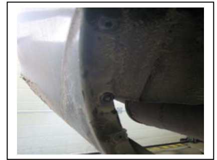
Stoßfängerbefestigung hinterm Schmutzlappen re. (auch li.)
