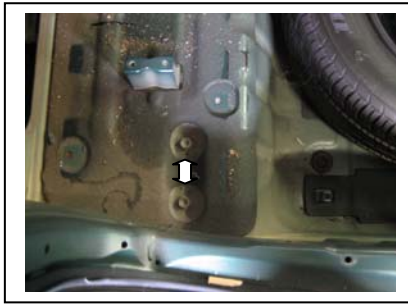
Stoßfängerbefestigung im Kofferraum li. (auch re.)
