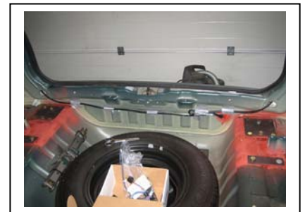
verlegte Leitung im Kofferraum
