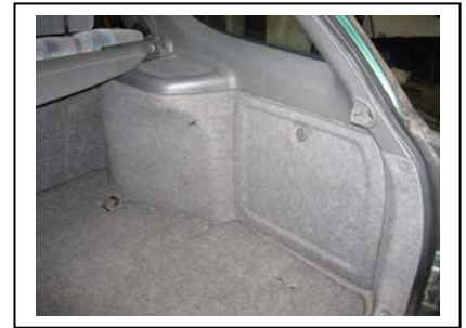
rechte Seitenverkleidung (3 versteckte Plastikclipse=> 2 unter Sitzbank, 1 zwischen der Rückenlehne)
