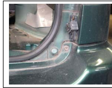
Stoßfängerbefestigung hinten rechts (auch links)
