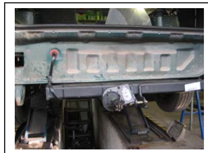
Montage Leitungssatz an der Anhängerkupplung
