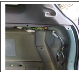
Leitungssatz re. Heckleuchte
