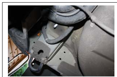
Befestigungspunkte Stoßfänger innen links mit Montageplatte
