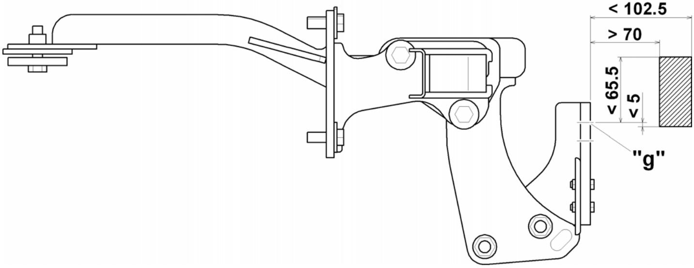
Kuppelbereich für Kupplungskugeln mit Halterung oder selbsttätige Bolzenkupplungen.
