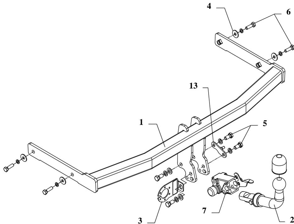
Die Anhängerkupplung (Katalognummer **SC19A**) ist für folgende Fahrzeugtypen zugelassen: **SEAT TOLEDO, 4 Tüer**, ab Bj. 05.1998 bis 2004, dient zum ziehen der Anhänger mit der Gesamtlast von **1600 kg** und der Kugelstützlast von max. **75 kg**.
