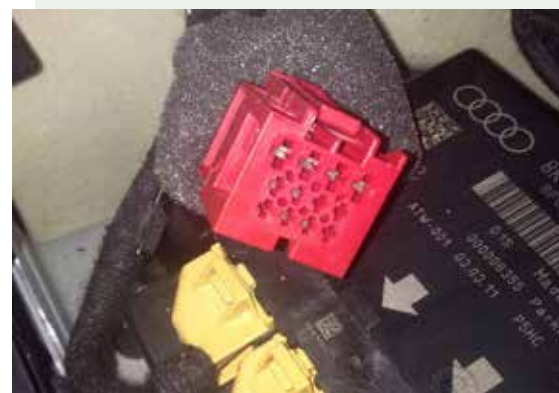
Abbildung: werkseitig vorbereiteter Stecker im Heckbereich für den einfachen Anschluss/Einbau eines Elektrosatzes z.B. bei Audi-Fahrzeugen
