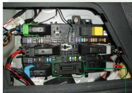
Abbildung: REC (Rear Electric Center) – Sicherungskasten im Fahrzeugheck z.B. bei Opel mit vorbereiteten Steckplatz für AHK-Modul
