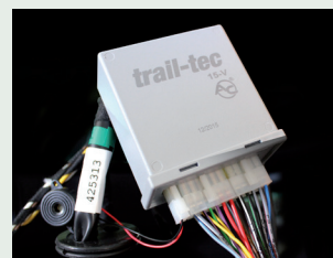
Schritt 4: alle Stecker und den akustischen Signalgeber auf das trail-tec-Steuergerät aufstecken
