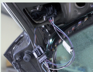
Schritt 2: Beleuchtungsfunktionen abgreifen (Heckklappe z.B. Nebelschleubleuchte oder Rückfahrcheinwerfer)
