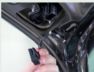
Schritt 1: Steckverbindung zur Leuchte trennen
