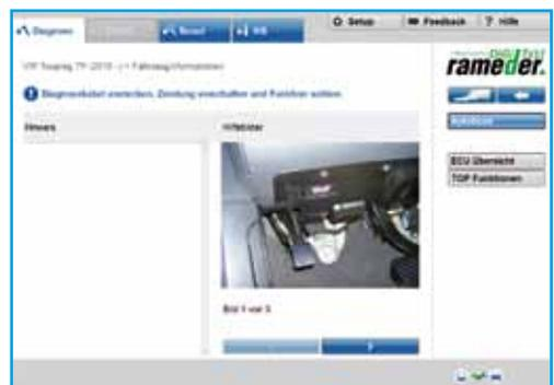
Anzeige zur Position des OBD-Stecker am Fahrzeug
