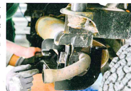
Durchgeführt: Das Kabel für die Steckdose der Anhängerkupplung wird durch den Fahrzeugboden geführt. Das Loch dafür ist bereits vorhanden und mit einer Gummikappe verschlossen.
