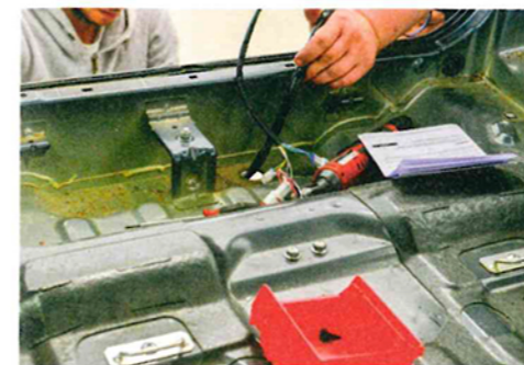
Durchgeführt: Das Kabel für die Steckdose der Anhängerkupplung wird durch den Fahrzeugboden geführt. Das Loch dafür ist bereits vorhanden und mit einer Gummikappe verschlossen.
