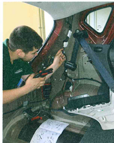
Hier ist der Einbau relativ einfach, doch oft muss der Monteur Kabel bis zur Zentralelektrik ziehen – und entsprechend viele Verkleidungen demontieren.
