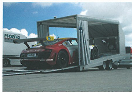
Die Seilwinde zieht das Rennfahrzeug auf den Trailer.
