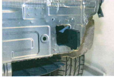
Die massiven Träger der Anhängerkupplung werden mit dem „Heckrahmen“ verschraubt.
