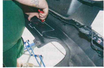
Der Ausschnitt für die Kupplung in der Heckschürze geht aus der Anleitung hervor.
