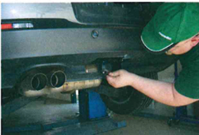
Nach der Montage der Heckschürze wird die Schwenkbarkeit der Steckdose getestet.
