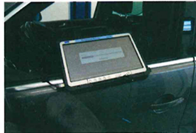
Mit dem Diagnosegerät muss die Anhängerkupplung freigeschaltet werden.
