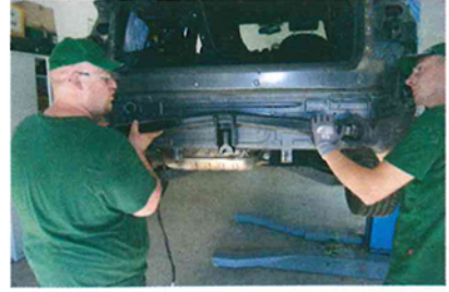
Das Verschrauben der Anhängerkupplungsaufnahme ist zu zweit leichter.
