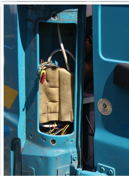
Nach Ausbau der linken Heckleuchteinheit kann der E-Satz der Anhängerkupplung am Fahrzeug verdrahtet werden
