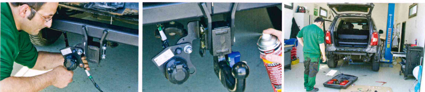
Als Nächstes die fertige Steckdose anbringen und die Kabel am Querträger verlegen. Nun noch die Schrauben sichern und mit Korrosionsschutz versehen. Hier hilft viel tatsächlich viel. Um die Funktion zu testen, müssen die Scheinwerfer wieder angebracht werden. Alles funktioniert. Also weiter.
