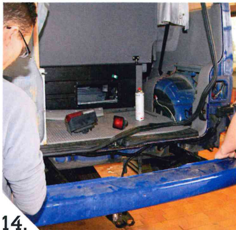
10. Zum Abnehmen der Stoßstange ist es hilfreich, einen zweiten Menschen zu haben, der zur Hand geht. Zunächst nur das Kunststoffteil.
