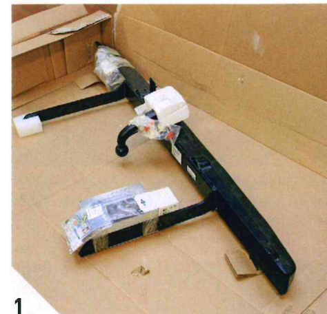
1. Nicht nur ein Haken kommt dran, es wird der ganze Stoßfänger gewechselt. Die Kupplung ist für den Transport falsch herum eingesteckt.
