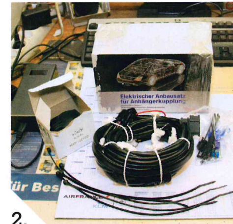
2. Mitgeliefert wird ein Kabelbaum und ein weiteres Blinkrelais. Dazu Kabelbinder, die das Kabelgewirr im Zaum halten.
