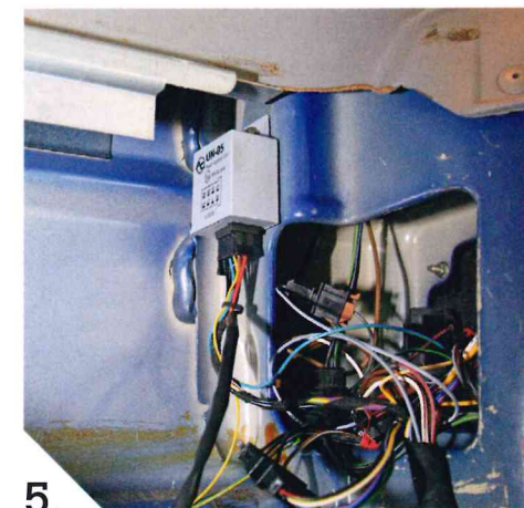
2. Mitgeliefert wird ein Kabelbaum und ein weiteres Blinkrelais. Dazu Kabelbinder, die das Kabelgewirr im Zaum halten.
