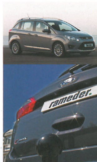
Beim Ford C-Max sorgen die Rameder-Kupplungen auch dafür, dass die Rückfahrwarnung im Anhängerbetrieb automatisch deaktiviert wird
