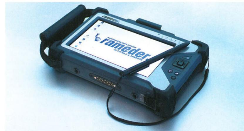
von AVL Ditest angebotenen Optionen bedarfsgerecht aufrüsten. Hierzu zählen beispielsweise die Standard-Diagnose für Pkw, Lkw, Busse und Trailer, eine geführte Fehlersuche und ein Informationssystem, Messwerte, das Anlernen von Baugruppen, Stellgliedtests und Messtechnik-Komponenten.
