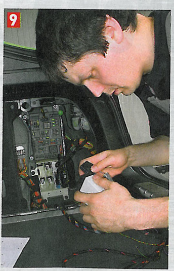
[7] Die Anhängerkupplung ersetzt den Original-Querträger des BMW und wird [8] rechts und links an den je vier vorhandenen stabilen Bolzen verschraubt. [9] Die Kabel werden im Kofferraum an die Bordelektronik angeschlossen. [10] Danach wird die Steckdose angeschraubt. [11] Der Aufkleber zeigt die Handhabung des abnehmbaren Hakens.
