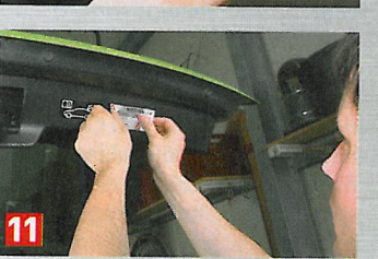
[7] Die Anhängerkupplung ersetzt den Original-Querträger des BMW und wird [8] rechts und links an den je vier vorhandenen stabilen Bolzen verschraubt. [9] Die Kabel werden im Kofferraum an die Bordelektronik angeschlossen. [10] Danach wird die Steckdose angeschraubt. [11] Der Aufkleber zeigt die Handhabung des abnehmbaren Hakens.
