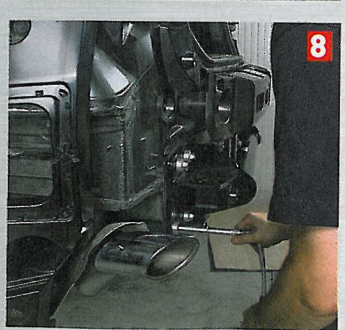
[7] Die Anhängerkupplung ersetzt den Original-Querträger des BMW und wird [8] rechts und links an den je vier vorhandenen stabilen Bolzen verschraubt. [9] Die Kabel werden im Kofferraum an die Bordelektronik angeschlossen. [10] Danach wird die Steckdose angeschraubt. [11] Der Aufkleber zeigt die Handhabung des abnehmbaren Hakens.
