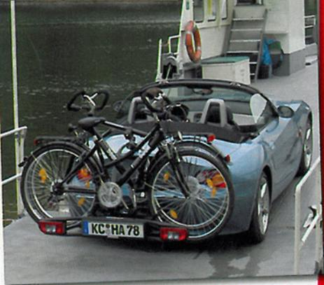
Für den BMW Z4 gibt es jetzt eine Anhängerkupplung (754 Euro) von Zubehörspezialist Rameder. Sie packt bis zu 1,2 Tonnen Anhängelast und nimmt max.75 Kilogramm Stützlast auf. Die Kupplung ist so konzipiert, dass auch ein Fahrradträger, z. B. das Modell „Portilo“ von Westfalia, montierbar ist. Der passende Elektrosatz kostet 145 Euro. [www.kupplung.de](http://www.kupplung.de)
