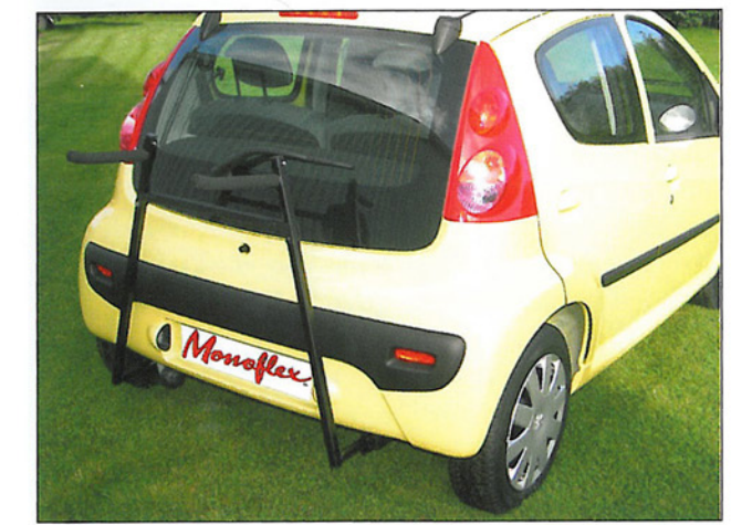
Dänische Variante: Die Bügel zum Fahrradtransport werden im Bedarfsfall mit dem Hilfsrahmen verbunden
