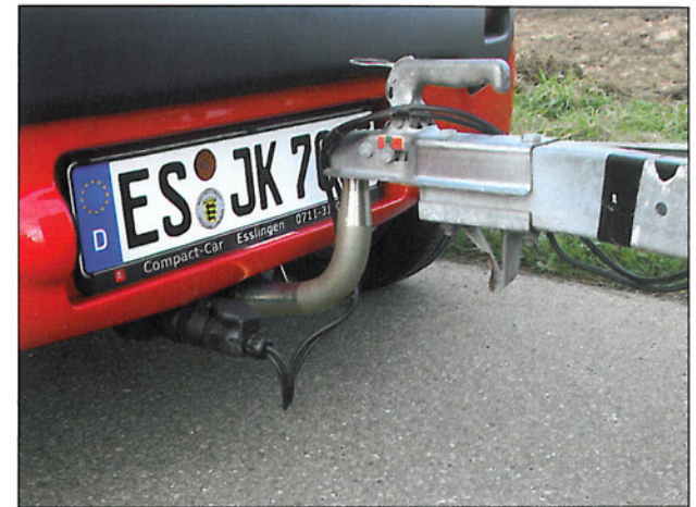
Anhänglich: Die praktische Anhängerkupplung ist wegen der Überdeckung des Kennzeichens hierzu Lande nur in abnehmbarer Ausführung lieferbar
