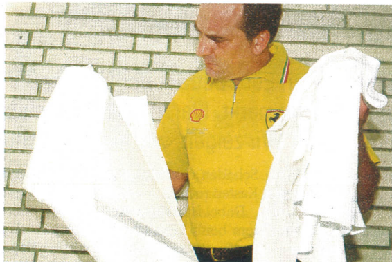
Schlau gemacht: Frittenfett-Profis aus dem Internet-Forum setzen auf das Klimaanlagevlies zum Vor- und Feinfiltern
