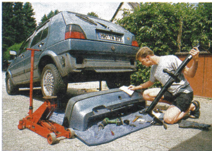
Voraussetzungen erfüllt: Montage der Anhängerkupplung am Frittenfett-Golf, Abholung der IBC-Container zur Lagerung. Diese Behälter finden sich meist bei Entsorgungsfirmen
