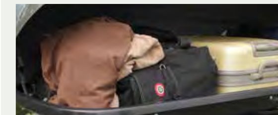
Schritt 4: Größere Hohlräume „ausstopfen“, am Besten mit einer Decke oder einem Schlafsack, verhindert zusätzlich das Verrutschen der Ladung und schützt zudem die Innenwände der Dachbox vor Kratzern.
