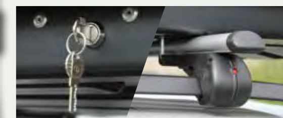
Schritt 5: Vor der Fahrt prüfen, ob die Box fest verschlossen ist (Nicht vergessen den Schlüssel abzuziehen!). Ist die Dachbox auch sicher auf dem Träger fixiert? Im Zweifelsfall noch einmal die Befestigungen nachstellen.
