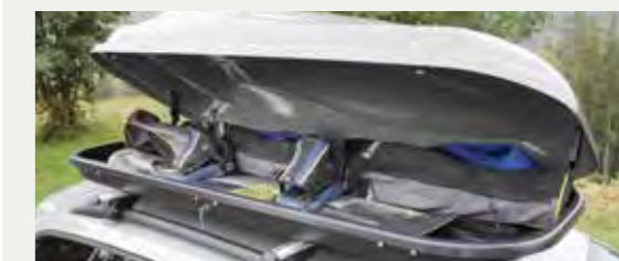
Schritt 1: Lange Gegenstände, wie z. B. Wasserskier oder Wakeboards, zuerst in die Dachbox packen. Das Gewicht gleichmäßig verteilen – schwerere Gepäckstücke bevorzugt mittig im Dachkoffer verstauen.
