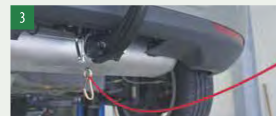
Anstelle des Original-Federhakens am Seil nutzen Sie einen Feuerwehrkarabiner (DIN 5299, L: mind. 70 mm) und klinken diesen direkt (ohne Schlaufe um den Kugelhalbs) in die Sicherungsöse / Langlochbohrung ein.
