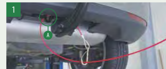
Fädeln Sie den Federhaken durch die Sicherungsöse (A) / Langlochbohrung an der Anhängerkupplungstraverse und formen Sie zusätzlich die Schlaufe um den Kugelhalbs; Klinken Sie den Haken am Seil ein.
