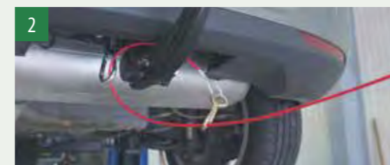
Fädeln Sie den Federhaken durch den in die Sicherungsöse / Langlochbohrung eingeklinkten Feuerwehrkarabiner (DIN 5299, L: mind. 70 mm); Dann formen Sie noch – wie bei 1 – die Schlaufe und klinken am Seil ein.
