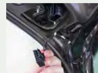
Schritt 1: Steckverbindung zur Leuchte trennen
