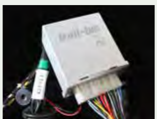
Schritt 4: alle Stecker und den akustischen Signalgeber auf das trail-tec-Steuergerät aufstecken
