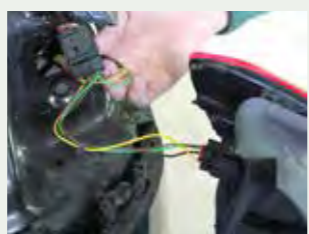
Schritt 3: weitere Beleuchtungsfunktionen (Licht, Blinker, Bremse) an beiden Rücklichtern abnehmen
