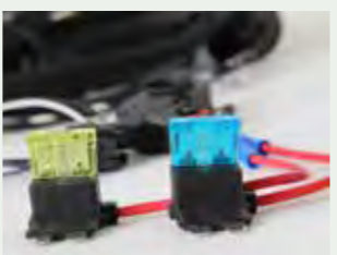
Schritt 5: Dauerstromanschluss im Sicherungskasten – optional auch über 12V Steckdose (mit Dauerstrom) im Kofferraum möglich
