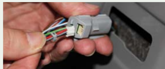
Schritt 3: Die Anschlussstecker des Steuergerätes in die dazugehörigen Sensoren einklinken.
