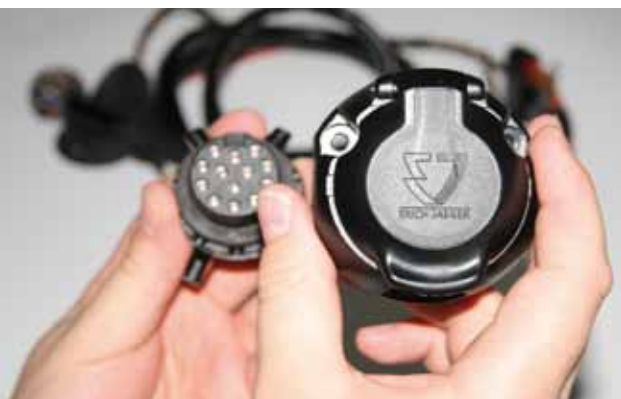
... der 13-polige Stecker – eine innovative Erfindung
