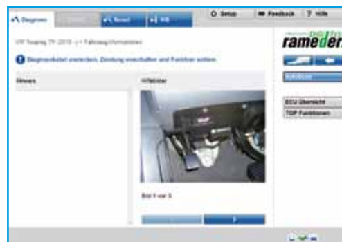
Anzeige zur Position des OBD-Stecker am Fahrzeug
