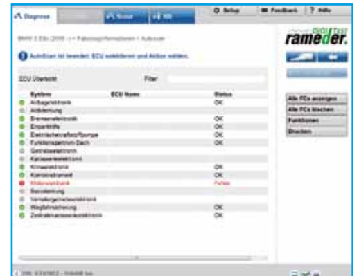
Anzeige IST-Daten mit Fehleranzeige
