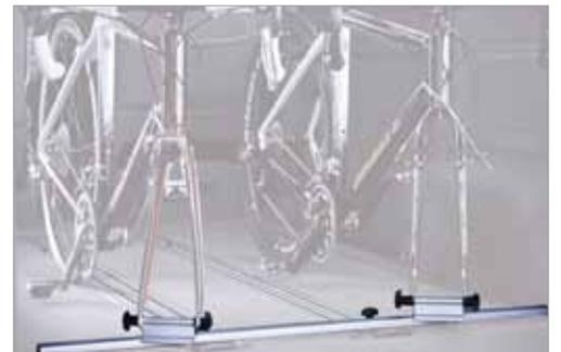
Der Fahrradhalter wird in den Schienen der Sitzbefestigung angebracht. Vorderrad muss demontiert werden. Verwendungsliste beachten, da dieser Fahrradhalter nicht universell einsetzbar ist.
