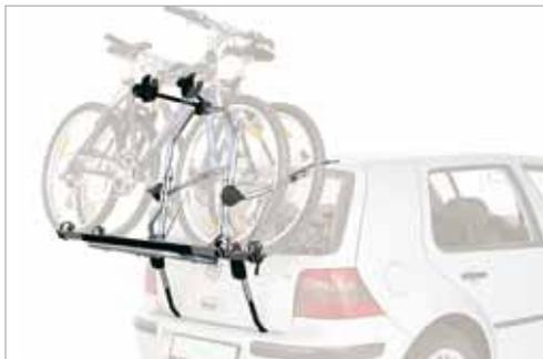
Montage erfolgt über Spannelemente, die an der Heckklappe befestigt werden. Zur Fahrzeugauswahl Verwendungsliste des Herstellers beachten. Nicht für Kfz mit Spoilern oder Kunststoffleisten am Heck.
