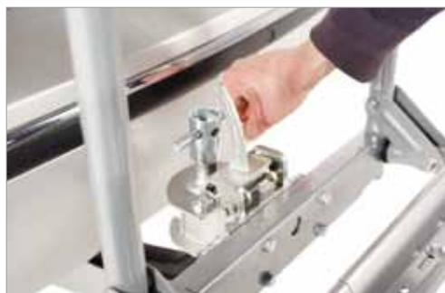
Mit dem beiliegenden Steckschlüssel sowie dem Montagestab den **Fahrradträger auf dem Kugelkopf arretieren**. Die **Sicherungsschraube** anschließend mit einem Drehmomentschlüssel **festziehen**.
