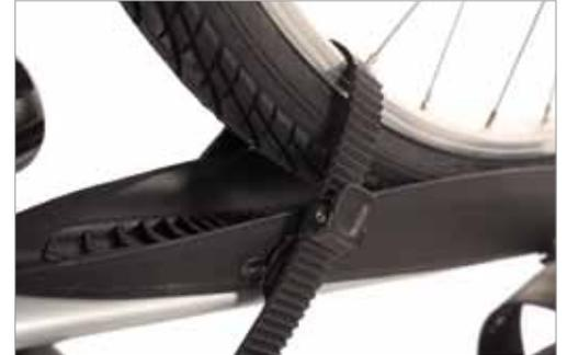
Zur zusätzlichen Sicherung der Fahrräder sind bei allen Fahrradträgern Reifenhalter vorhanden. Diese sind individuell einstellbar.
