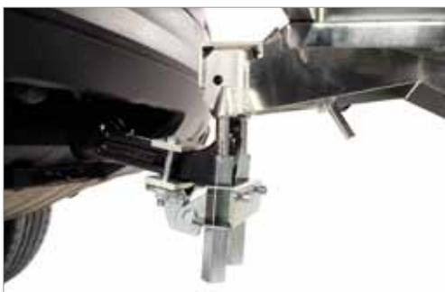
Den **Fahrradträger** mit den Führungsbolzen senkrecht **in die Stabbuchse einsetzen** und mittels einer Knebelmutter **arretieren**. Für Anhängerkupplungen mit vierkantigem Kugelkopf ist ein zusätzlicher Adapter (ZB0160) erhältlich.
