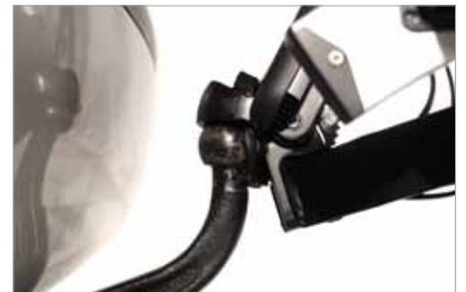
Hebelverriegelung vor dem Aufsetzen vollständig öffnen und den **Fahrradträger auf den Kugelkopf setzen**.
