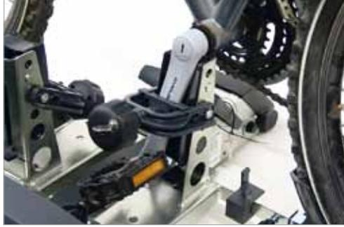
Mit einer Kralle wird das Fahrrad an den Pedalarmen befestigt.
