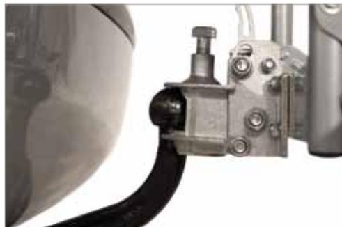
**Fahrradträger** waagrecht **auf den Kugelkopf** der Anhängerkupplung **schieben** und horizontal ausrichten.
