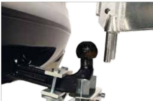
Die **Stabbuchse** am **Kugelkopf** der Anhängerkupplung **befestigen** und ausrichten.
