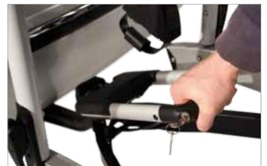
Anschließend den integrierten **Spannhebel** des Fahrradträgers vollständig **nach unten drücken** und Diebstahlsicherung arretieren. Bei allen Spannvorrichtungen ist die **Diebstahlsicherung** für den Fahrradträger **enthalten**.
