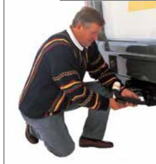
Montage des abnehmbaren Kugelkopfes
