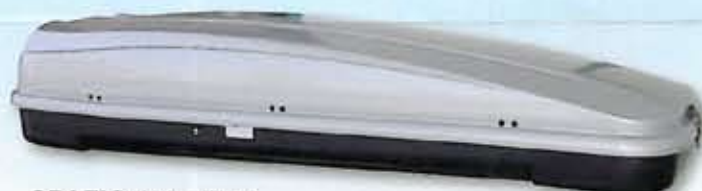
SPAZIO 460 silber 460 Liter Ladevolumen · L/B/H: 2250 mm x 650 mm x 430 mm · Eigengewicht: 18 kg · Zuladung 50 kg · Schnellmontagesystem „Easy-Block“
